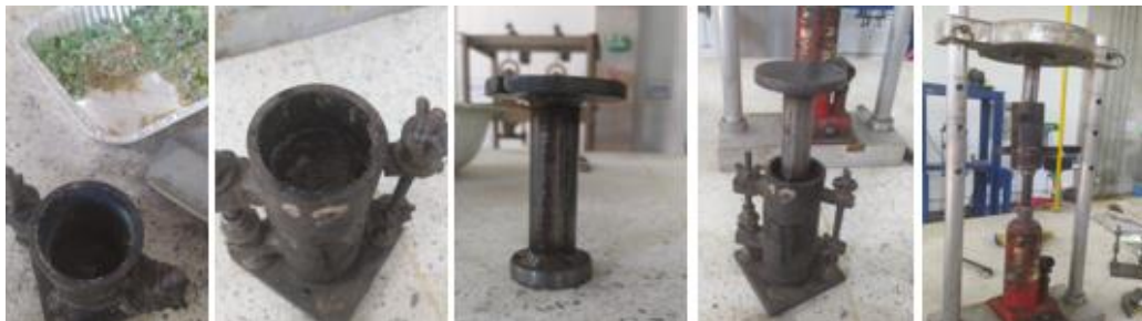
Figura 3. Anexos Compactación y mezclado de las probetas. Fuente: Propia.
