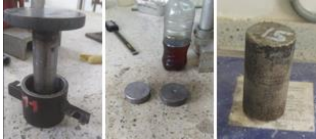
Figura 4. Anexos Desencofrado de probetas. Fuente: Propia.
